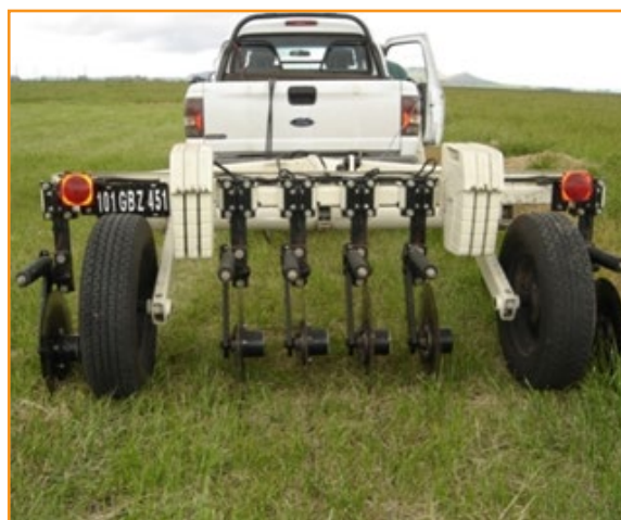
Figura 2. Veris 3100® remolcado por una pick-up en una pastura de agropiro alargado.
