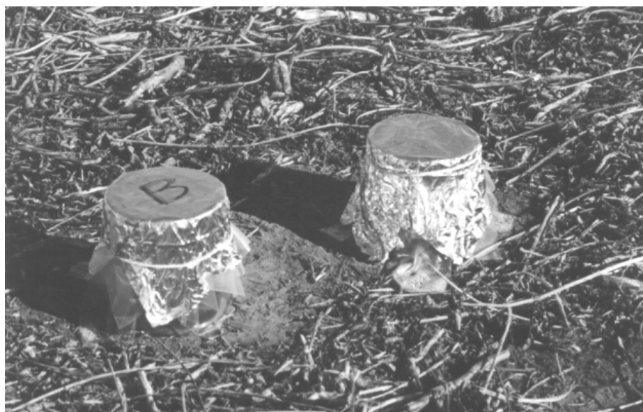
Foto 2: Detalhe das câmaras para medir respiração no campo. À esquerda o cilindro correspondente ao branco.
