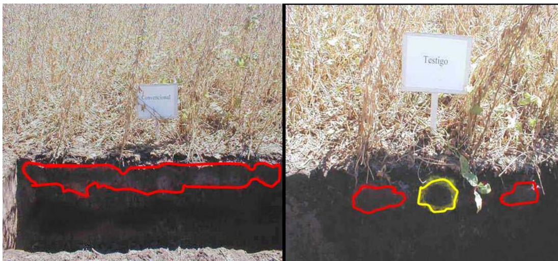
Fotografías 3 y 4: Estados estructurales en los tratamientos RC (rodado convencional) izquierda y T (testigo) derecha. En rojo estados M \Delta (masivos delta, sin porosidad visible), en amarillo estados SD \Delta (terrones soldados sin porosidad visible).
