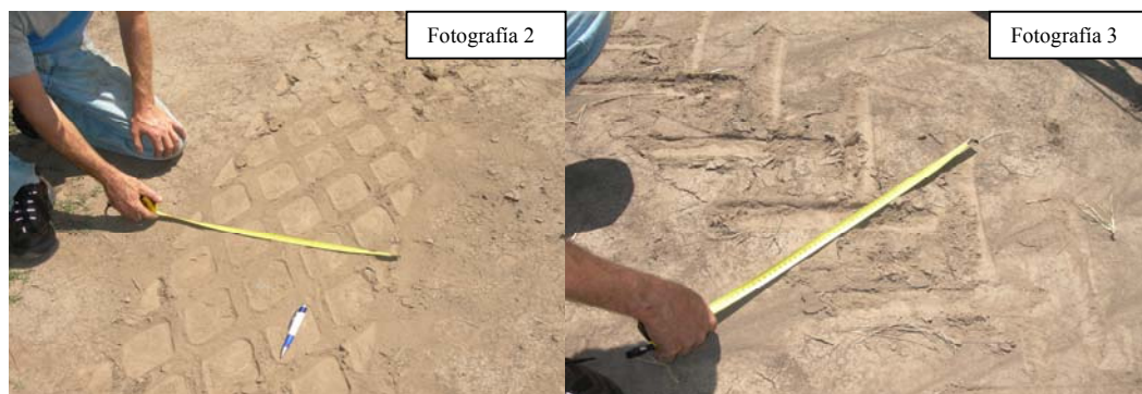
Fotografías 2 y 3: Detalles de la determinación del ancho de huella para el cálculo del área de contacto en los tratamientos RE (rodado especial) izquierda y RC (rodado convencional) derecha.
