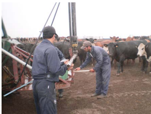
Fotografía 2. Muestreo de suelos a profundidad (0-90 cm) en sitios comerciales de engorde intensivo a corral. El muestreo se realizó con un calador hidráulico en tres puntos de cada corral.
